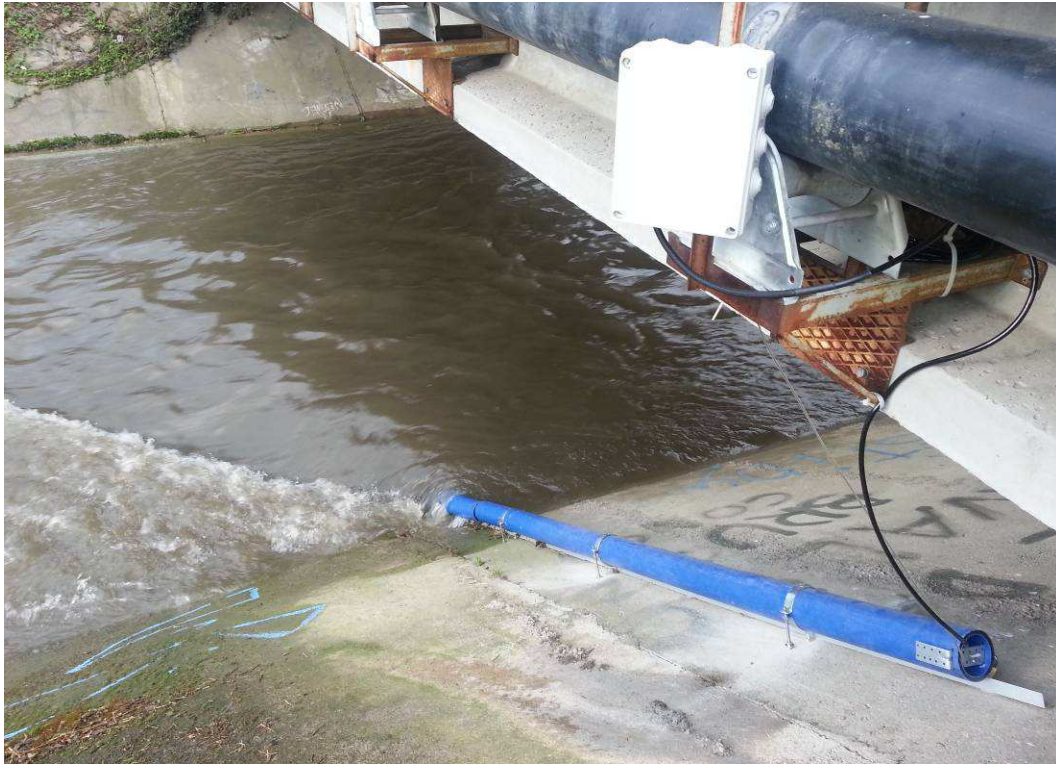
Figura 28 – Installazione della sonda S/N 13M101704 all'interno del CSNO
