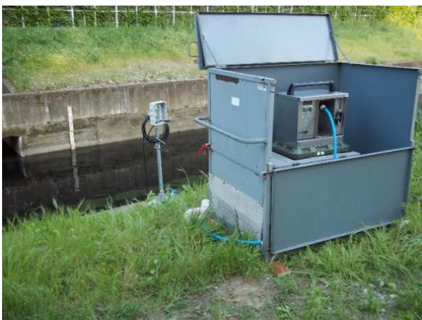
Figura 30 – Autocampionatore installato sul T. Seveso
