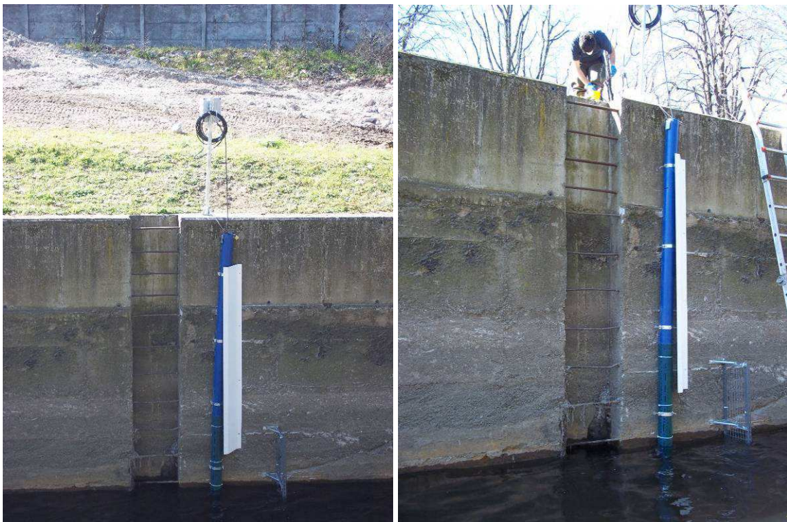
Figura 28 – Installazione della sonda S/N 13M101704 all'interno del CSNO
